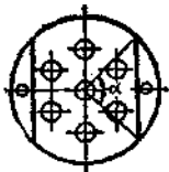
Рис. VIII.9. Размещение колпачков на тарелке
